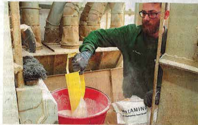
Feinabstimmung: Mitarbeiter Michael Pessica fügt an der Chargenwaage 3 dem Futter eine Mineralmischung bei.
