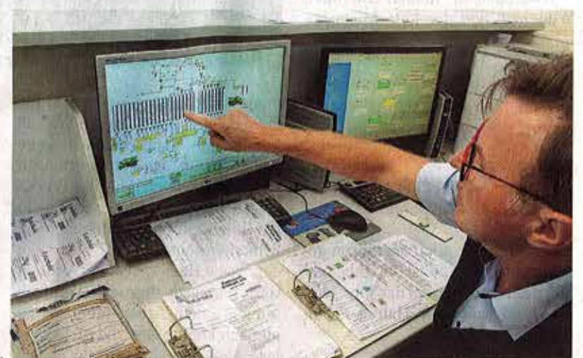
Sigmar Benz, Leiter Futtermittel, demonstriert in der Steuerzentrale die Arbeitsprozesse. Die senkrechten roten Streifen verbildlichen die 31 Rohstoffzellen.
