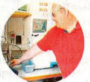
Probe in den **Probenreiniger**. Dort wird das Sortiergetreide vom unwertbaren Ausputz getrennt und das Verhältnis beider Fraktionen zueinander ermittelt. Dritte Station ist das **Ganzkorn-Messgerät**. Hier werden unter anderem der
