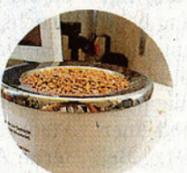
Nummer fünf der **Sortimat**. Dieser sibt die Körner nach festgelegten Größen. 90 Prozent der Körner müssen größer als 2,5 Millimeter sein, sonst gibt es Abzüge von der Mälzerei. Für Weizen ist Station Nummer fünf das **Fallzahlen-Messgerät**. Anhand einer gemahlenen Probe werden die Klebeeigenschaften ermittelt. Dies ist für den Backvorgang von Bedeutung. jök
