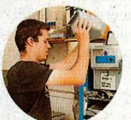
Feuchtigkeitsgehalt, der Proteingehalt und das Hektolitergewicht ermittelt. Die vierte Station ist das **Vakuummessgerät**. Aus der Probe wird ein etwa 500 Gramm schweres Rückstellmuster einvakuiert und mit einem Rückstell-Etikett versehen. Das Muster dient zur späteren Nachverfolgung, etwa bei Reklamationen. Für Braugerste ist Station
